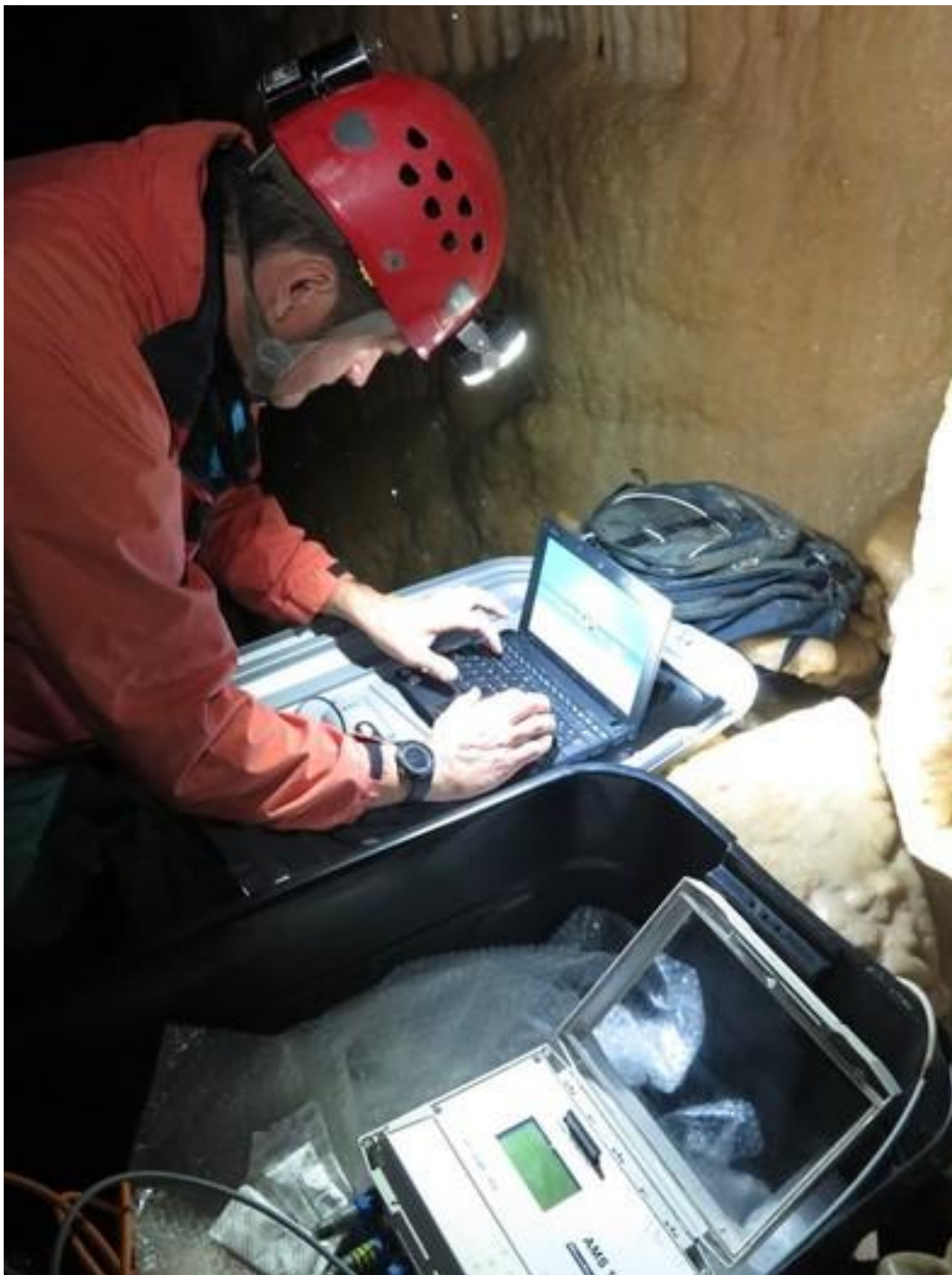
Vzpostavlanje meteoroloških meritev v Postojnski jami. Podobne meritve temperature, vetra in koncentracije ogljikovega dioksida potekajo še v nekaterih drugih jamah, tudi v Škocjanskih
