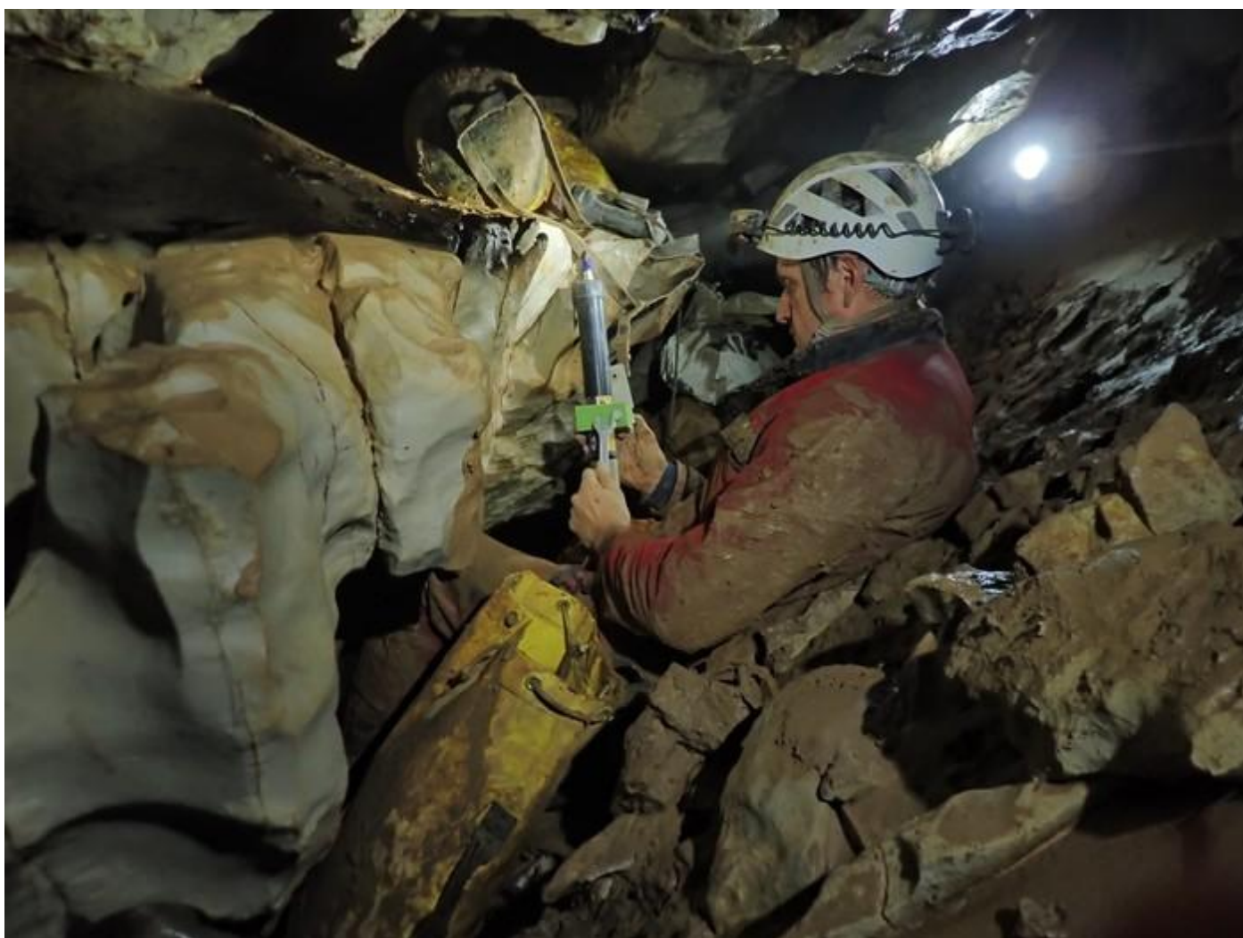
Nameščanje sonde za merjenje lastnosti podzemne vode v jami Ždink na robu Pivške kotline
